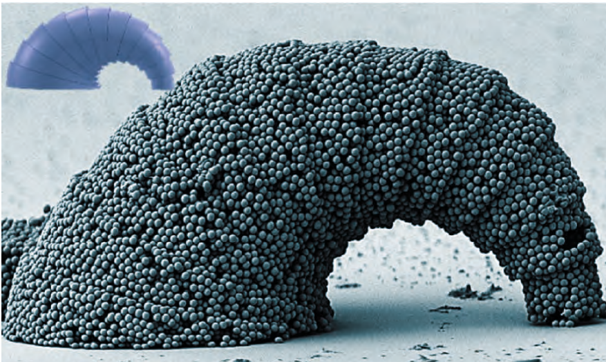
Silisyum dioksit ( \text{SiO}_2 ) parçacıklarından oluşan 3D bir mikro yapının taramalı elektron mikroskobuyla elde edilmiş görüntüsü
