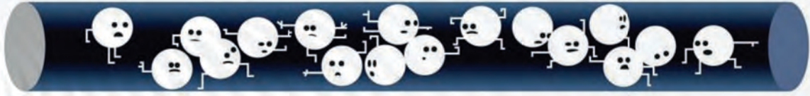
1 Normal bir iletkende elektronlar birbiriyle ve içinde bulundukları malzemeyle çarpışarak yol alır.
