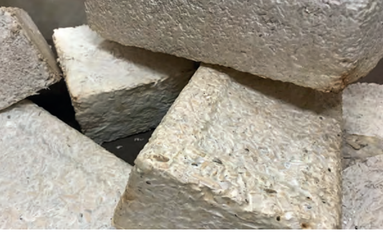
Miselium, bitkisel atıklar ve odun talaşından üretilen malzemeler.
