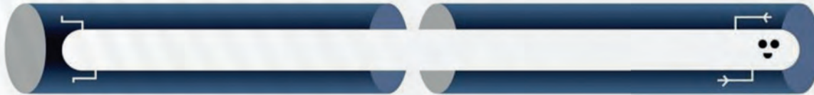
3 Cooper çiftleri tüm elektrik devresini dolduran tek bir parçacık gibi davranır. Kuantum mekaniği bu kolektif durumu ortak bir dalga fonksiyonu ile tanımlar. Bu dalga fonksiyonunun özellikleri Nobel Ödülü'nü kazanan fizikçilerin deneylerinde başrol oynadı.
