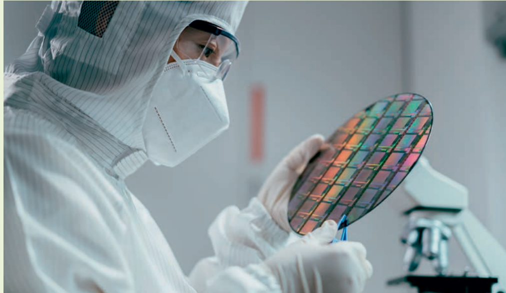
Bir mühendis, çipin üretim aşamasında kullanılan silisyum levhayı inceliyor. Her bir levha daha sonra kesilerek birçok küçük çipe dönüştürülüyor ve bu çipler, elektronik cihazlarımızın beynini oluşturuyor.
