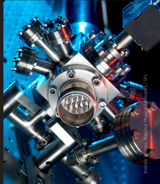
Stronsiyum iyon kapanı. Bu kapan bir stronsiyum optik saatinin bileşenlerinden.
