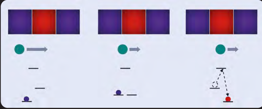
Sisyphus soğuması sırasında, bir polarizasyon bölgesinden diğerine doğru yol alan bir atomun iç enerjisi artar, hareket enerjisi azalır. Atom, bir sonraki polarizasyon bölgesine geçtiğinde lazerle etkileşerek iç enerjisini azaltır. Ancak kaybettiği hareket enerjisini geri kazanamaz.
