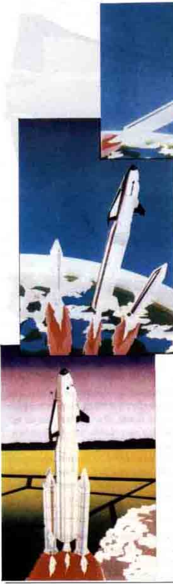
Hermes'in uçuş plânı: Fırlatıcı "cryotechnique" bölü- mün ateşlen- mesi, 5 da- kika sonra barutlu iki fırlatıcının yanışı ve kalkışı(1); 120 saniye- nin sonunda barutlu fırlatıcıların yanmalarının bitişi ve ayrılma(2); 600 saniyeye kadar "cryotechnique" fırlatıcının ateşlenerek ayrılması ve Hermes fırlatıcı modülünün yola çıkışı (3); uçağın, böylece bağımsız bir fırlatma sistemine sahip olması(4).
