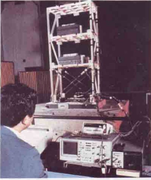
Bir bilim adamı, binaları sarsıntıların yıkıcı zararlarından korumak amacıyla tasarlanmış lastik izolatör-lü platform modelini çeşitli testlerden geçiriyor.
