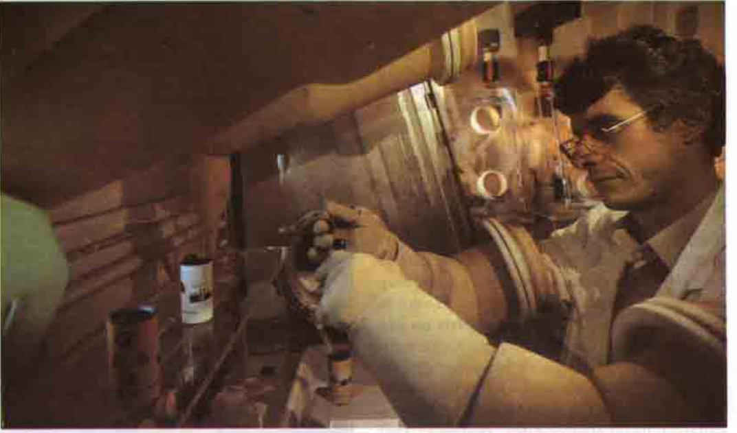
Fosfor-32 ya da iyot-125 gibi radyoaktif elemanlar, biyolojide moleküllerin işaretlenmesi için sıklıkla kullanılmaktadır. Araştırmacılar buradaki CEA laboratuvarındaki gibi pleksiglastan koruyucu bir ekran arkasında ve özel eldiven ile çalışabilirler, gene de biyolojik testlerle radyasyon kontrolü yaptırılmalıdır.
