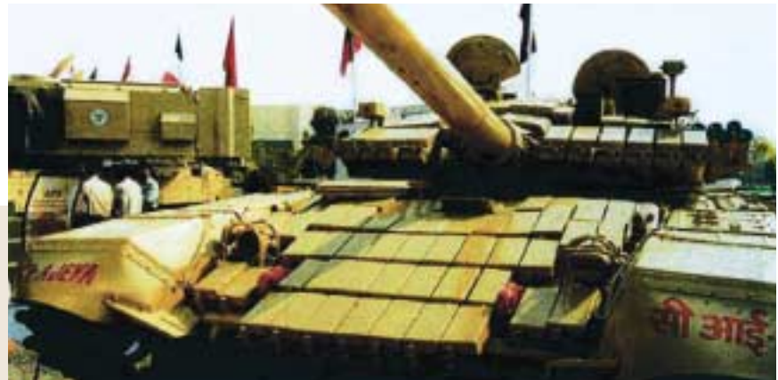
ABD seyretilmiş uranyum mermilerini, Rusların Varşova Paketi ordularında hizmet soktuğu, çok güçlü bir zirha sahip T-72 tanklarına (üstte) karşı geliştirdi. Amerika'nın Irak'ta ve Kosova'da kullandığı M1A1 Abrams tankları için geliştirdiği mühimmat (ortada) Mermi tanka çarptığında bu uranyum çok yüksek bir sıcaklıkta yanıyor, zirhı eriterek tankın içine giriyor. Sağda bir DU mermisinin deldiği zirh görülüyor.
