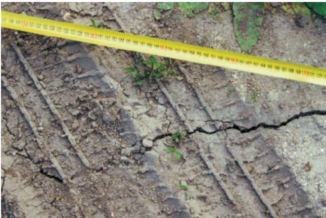
Otabayındır köyünde izlenen yüzey çatlaklarından biri. Şeritmetre çatlakın genel doğrultusunu gösteriyor. Güldürcek barajı kuzeyi, Kayıvıran'da izlenen bir blok düşmesi.
