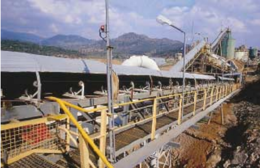
Yürüyen bantlarla kırıcıya gelen cevher, önce çeneli kırıcıdan geçiyor. Daha sonra titreşimli elekte istenilen tane boyutunu yakalayan parçacıklar, elekten geçerken, geçemeyenler yeniden kırıcıya gönderiliyor.
