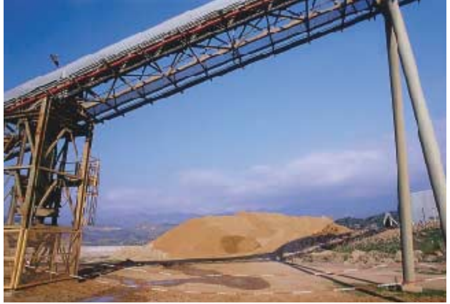
Elekten geçen mıcır boyutundaki cevher, yine bantlarla kireç ilavesi yapılan üniteye getiriliyor. Daha sonra, değirmenlere taşınan karışım, altının serbestleşme boyutu olan 38 mikrona kadar öğütülüyor.
