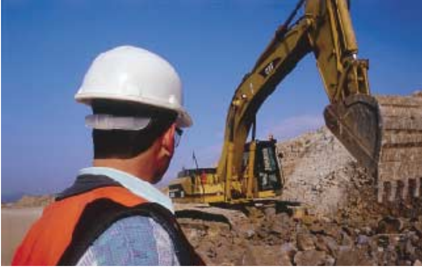
Patlatmayla gevşetilen toprak, ekskavatörlerle cevher stok alanına taşınıyor. Burada cevher, tenör oranına göre sınıflandırılıyor.
