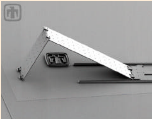
Bu MEMS'de bulunan mikroayna, bağlı bulunduğu dişli sistemi ve tarak biçimli iticiler sayesinde hareket edebilir.
