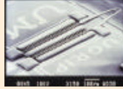
Deneysel amaçlı yapılmış bir "mikrocımbız". Tarak biçimindeki bölgeye elektrik akımı verildiğinde, tarağın dişleri elektrostatik olarak birbirlerini çeker ve cımbızın ucu kapanır.
