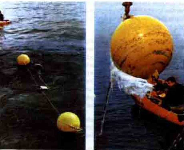
Akıntı ölçer sistemlerin kayıt sonlarında denizden çıkarılışı ve geriye alınışları.
