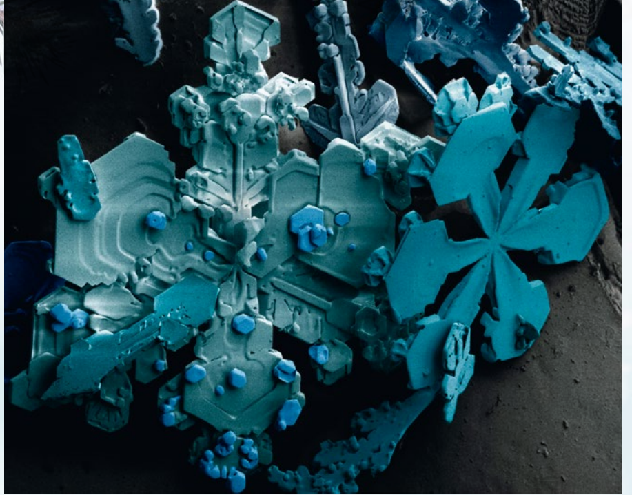
Düşük sıcaklıkta, taramalı elektron mikroskobu ile çekilmiş bir kar kristali fotoğrafı
