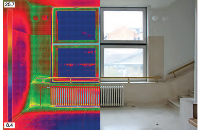
Bir binadaki ısıtıcıların ve pencerelerin sıradan (sağda) ve termal kameralarla (solda) alınmış görüntüleri
