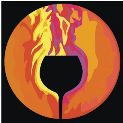
Şekil 12. Sıcak su dolu kadehin renkli iz fotoğraflama yöntemi ile elde edilen görüntüsü
