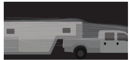
Şekil 4. Kamyonetin etrafındaki hava akışının dumanla görüntülenmesi
