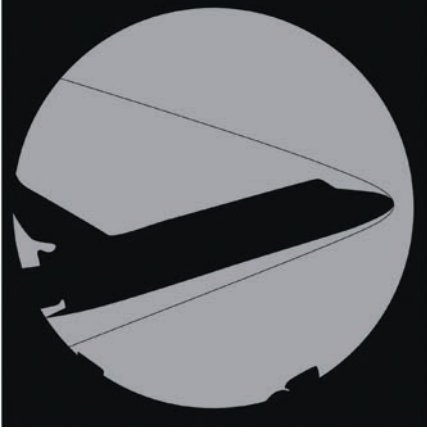
Şekil 6. Hızı ses hızının yedi katı olan uzay mekiğinin etrafındaki akışın gölge grafiği
