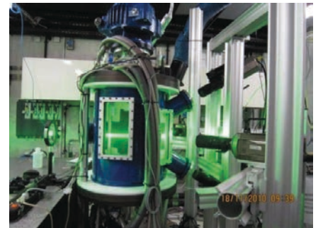
Şekil 10. Dört kameralı ayrıışık parçacık hızı görüntüleme düzeneği
