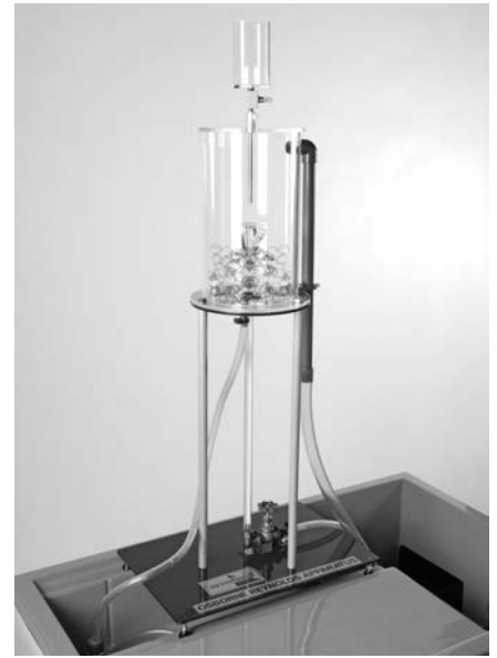
Şekil 3. Reynolds test aleti
