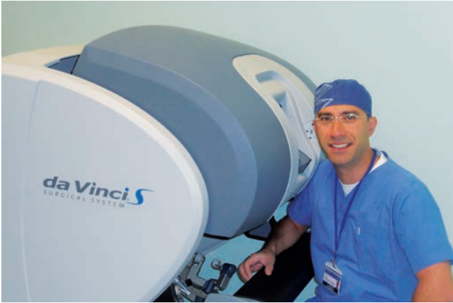
Robotik kolların uçları, konsolda oturan cerrahın elinin tüm hareketlerini aynen ve hiç titirmeden yapar. (Doç. Dr. Abdullah Erdem Canda, Ankara Atatürk Eğitim ve Araştırma Hastanesi, Robotik Cerrahi Ameliyathanesi)
