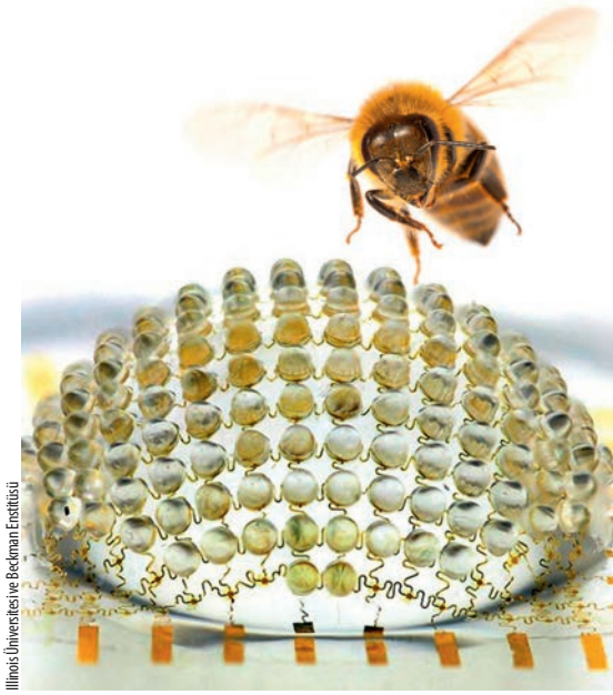
Yaklaşık olarak bir yarımküreyi kaplayan toplam 180 yapay ommatidiumdan oluşan yapay böcek gözü kamera
