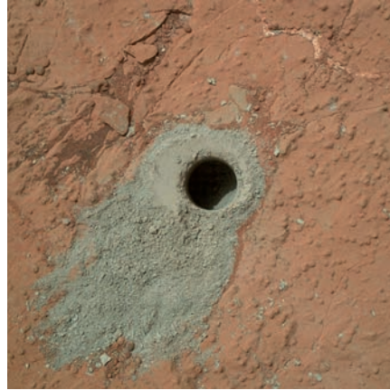
Curiosity tarafından Mars yüzeyinde açılan (6,6 cm derinliğinde) delik
