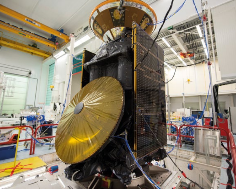
ExoMars TGO uydusu ve Schiaparelli isimli Mars'a giriş, alçalma ve iniş deneme modülü titreşim testleri sırasında. (ESA-S. Corvaja, 2015)
