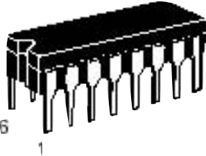
Şekil 1. JK tipi flip-flop olarak SN54/74LS112A entegresi seçilebilir. Ayrıntılı bilgiyi, satın aldığınız yerden veya internette edinebilirsiniz.
