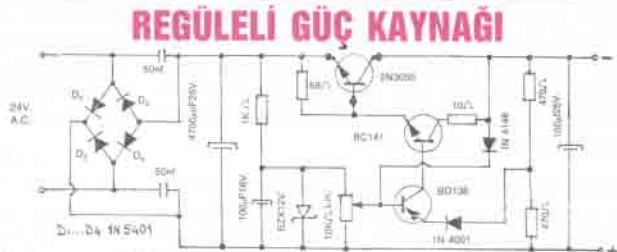
3 Amper, 0-24 Volt Ayarlı Kısa Devre Korumalı ve Regüleli DC Güç Kaynağı Devresi.
