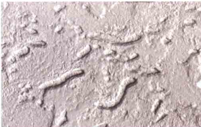
Bu ölçekte pürüzlü yüzeyli ve ince zerrelili silisilikat parçalarının (<40 nm) fazlasıyla büyüdüğü görülüyor. Bizim ilgilendiğimiz formlar, 0,7-0,8 mikrometre boyutlarda. Formları, silisilikatlar kapladığı için bu şekillerin oluşumlarının silisilikatların oluşumundan biraz önce ve Dünya-dışı kaynaklı olduğu düşünülüyor.
