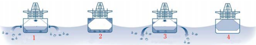
1-Geminin kargosu boş olduğu zaman suya oturabilmesi için balast tanklarına limandan balast suyu alınır. 2-Seyir esnasında balast tankları doludur. 3-Varılan limanda balast tanklarındaki su boşaltılır. 4-Kargo dolu ol- duğundan balast tankları boştur
