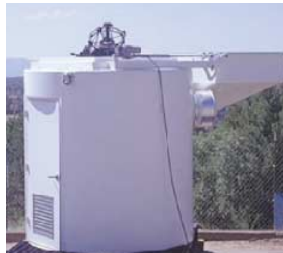
Şekil 4: ROTSE-3'ün 45 cm'lik teleskopunun ucu, koruyucu silindirden çıkmış olarak görülüyor.
