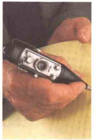
Tükenmez kalem fotoğraf makinesi, 1953'te Japonlar tarafından yapılan bu makine gerçekten yazabiliyor da.
