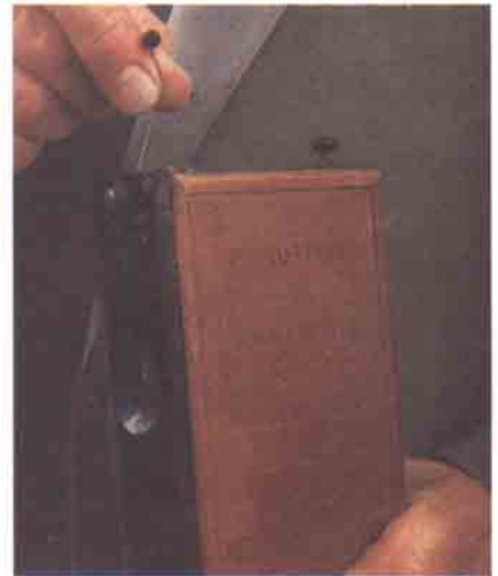
1888 Alman yapımı Photo-Livre, ismi gibi bir kitap görünümündeydi. Bu makineyle 24 poz çekilebiliyordu.
