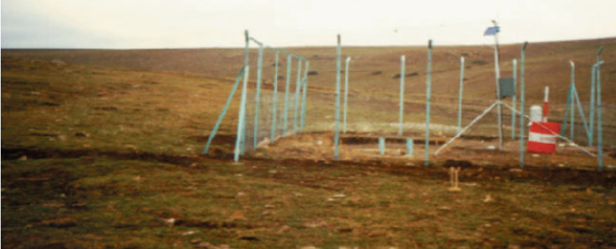
Doğu Anadolu'da (Ilıca) 2200 metre yükseklikte kurulu tam otomatik kar istasyonu. Toprak altında 4 adet 1 m 2 'lik çelik kar yastığı bulunmakta. Güneş enerjisi ile beslenen istasyonlardan veriler uydu aracılığıyla merkeze aktarılmakta.
