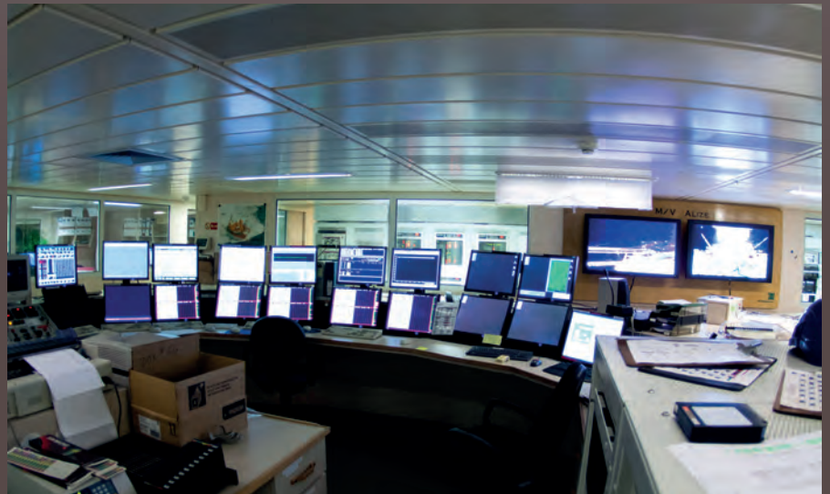
Şekil 6. CGG Alize sismik arama gemisinin kayıt ve veri kontrol odası.
