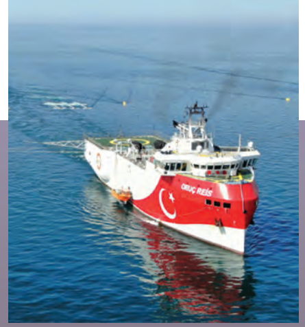
Şekil 9. MTA Oruç Reis sismik arama gemisi üç boyutlu sismik veri topluyor.
