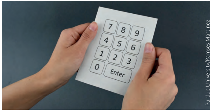
Purdue Üniversitesinden mühendisler, herhangi bir kâğıt veya karton ambalajı bir klavye, tuş takımı veya diğer kullanımı kolay bilgisayar ara yüzlerine dönüştürebilen basit bir baskı işlemi geliştirdi.
