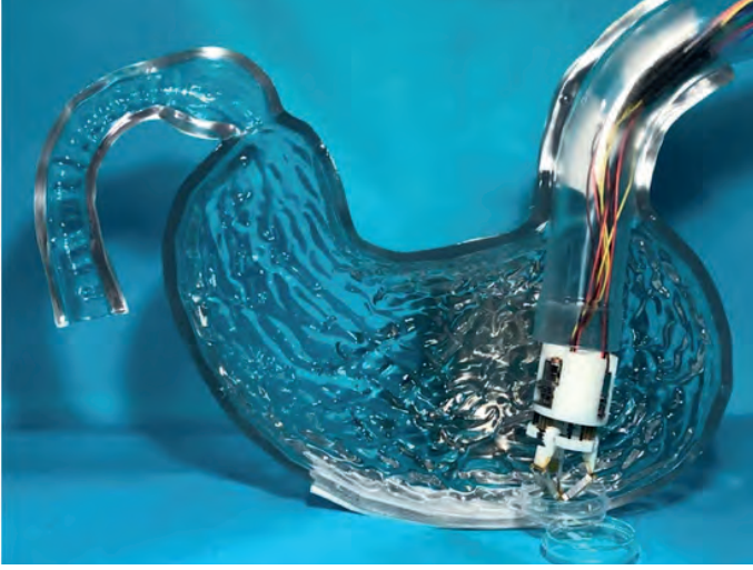
Mide modelinde mini robot ile biyobaskılama gerçekleştirilebiliyor.
