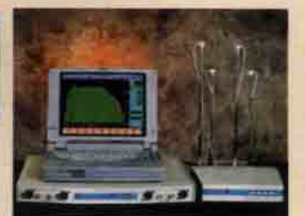
Ortamın akustik modeli, hassas alıcılar ve bilgisayar yardımıyla çıkarılır. Elde edilen model ses yükseltici aygıtların yayın parametrelerini değiştirmede kullanılır.
