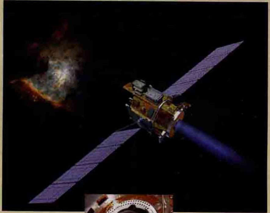
Deep Space 1, NASA'nın Yeni Bin Yıl Programı kapsamında gönderilen ilk uzay aracı. İçerdiği iyon motorlarının yanı sıra 11 yeni teknolojiyi daha barındırıyor. Amacı asteroid ve kuyruklu yıldızları incelemek.
