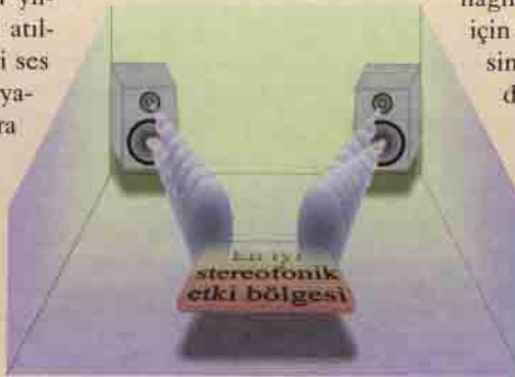
En iyi stereofonik etki için dinleyicinin ses kabinlerinin simetri ekseninde bulunması ve ses kabinleriyle altmış derecelik bir açı yapacak biçimde durması gerekir.
