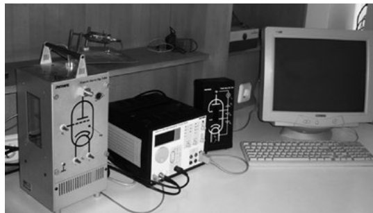
Hacettepe Üniversitesi Fizik Mühendisliği Bölümü'ndeki Franck-Hertz deneyi düzeneği
