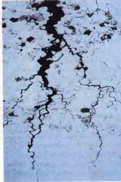
Şekil 9. Çelik bir levhanın yapımı sırasında oluşan çatlak. (Guyon & Stanley, a.g.e)
