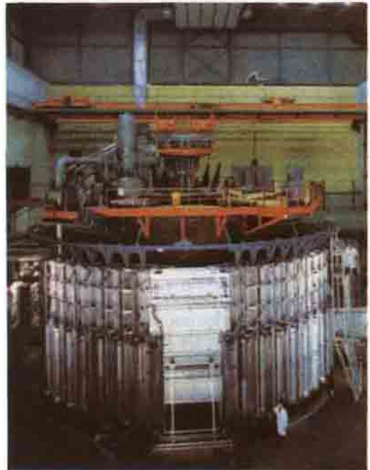
Simetri ilkelerini doğrulamak için, nötrino-proton çarpışmalarının yapıldığı, CERN'deki BEBC kabarcık odası.
