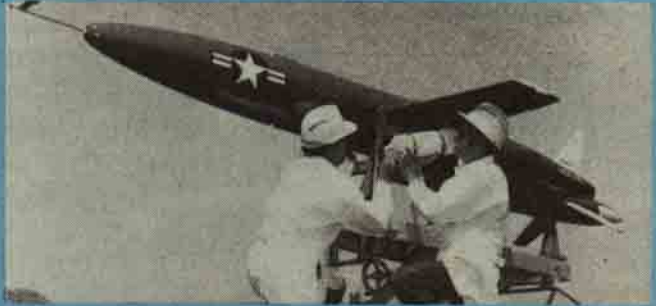
Gerektiğinde roket tespit tesisleri atılır, böylece uçak her yere inebilir.
