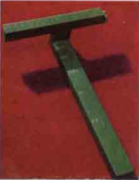
M.Ö 8. yüzyıldan önce yapılmış taşınabilir bir güneş saati. Saat, kısa parçanın gölgesinin sap üzerindeki skalaya düşmesi için güneşe doğru tutuluyordu.
