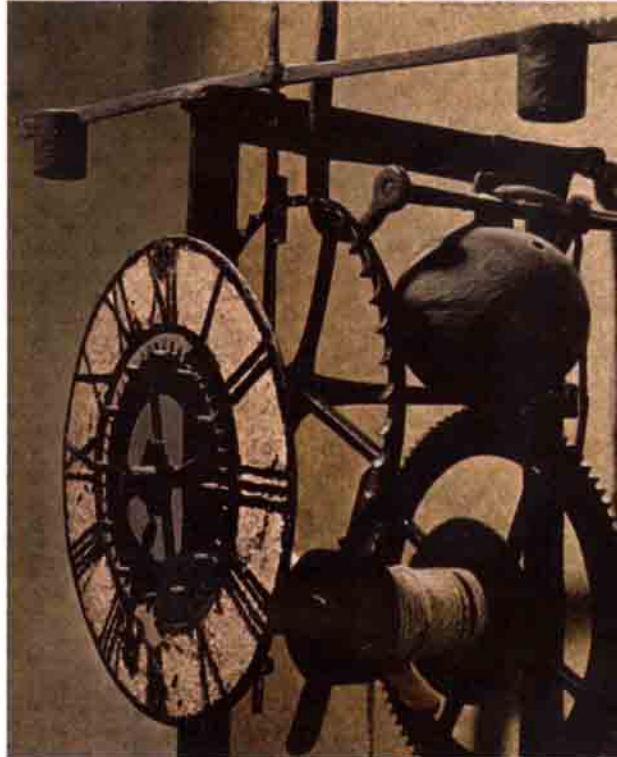
Ağırlıkla çalışan ilk mekanik saatlerden. Kısa aralıklarla duran ve inen ağırlık, saat mekanizmasını günün uzunluğuna ya da kısıtlılığına bağlı olmaktan kurtarıyor.
