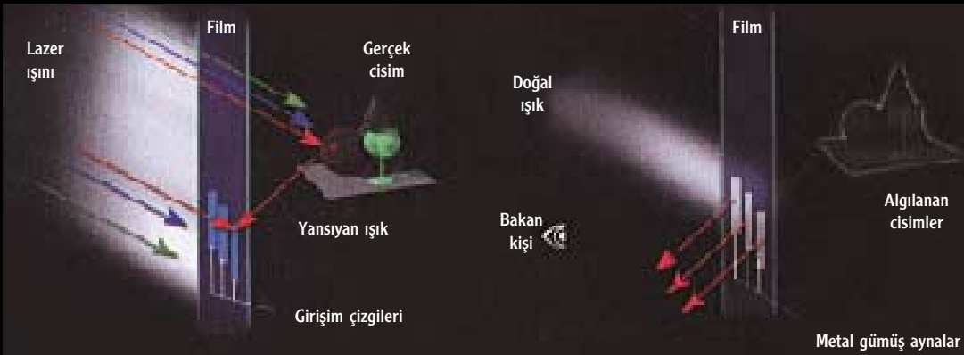
Gentet'in renkli hologram tekniği Denisjuk'un yıllar önce geliştirdiği ama uygulayamadığı tekniğin hayata geçirilmiş hali
