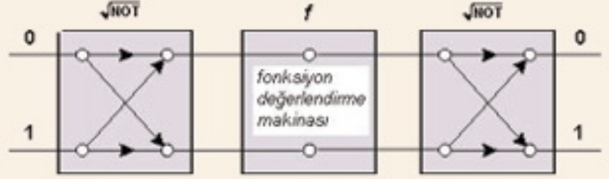
Şekil 3: Deutsch'un tek hesaplamada, f fonksiyonunun tipini belirleyen kuantum hesaplamasının şematik gösterimi.
