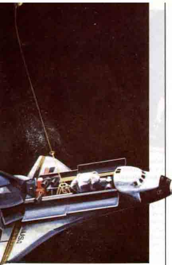
1991'de, NASA, kendisine 20 km uzunluğundaki halatla bir uyduyu bağlanmış uzay mekiğini uçurmayı planlıyor. Halatın, Dünya'nın manyetik alanı içerisinde hareket ederken, elektrik akımı oluşturması bekleniyor.
