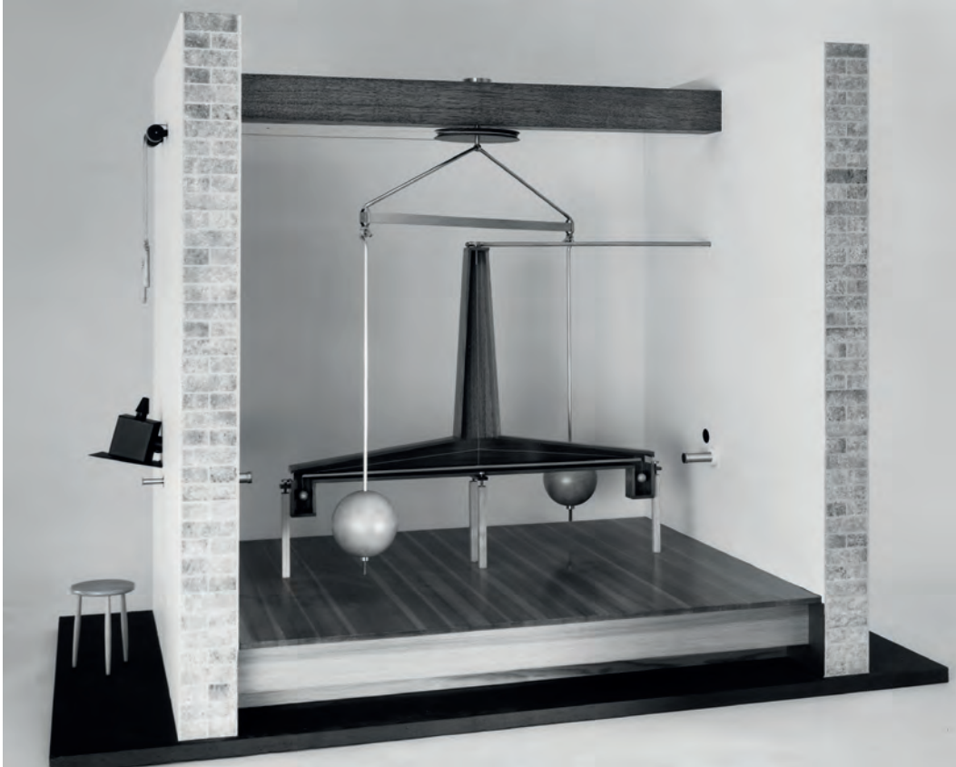
Cavendish'in deney düzeneği temel olarak iki ucunda küçük kurşun küreler bulunan oldukça hafif bir çubuktan oluşuyor. Bu çubuk bir tel ile tam orta noktasından asılıyor. Daha büyük kurşun kürelerin bu küçük kürelere yaklaştırılmasıyla birlikte kütleçekim yasasına göre meydana gelen çekim bir döndürme momenti oluşturuyor. Telde oluşan dönme açısı ve telin elastik özellikleri kullanılarak kütleler arasındaki çekim kuvveti hesaplanabiliyor.
