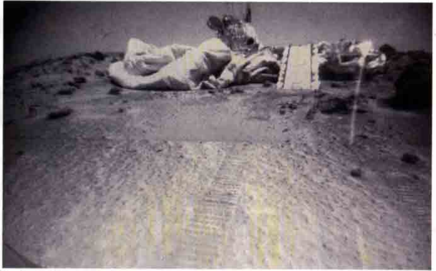
Bu fotoğraf Sojourner'in kamerasıyla çekilmiş. Fotoğrafta Pathfinder (ya da şimdiki adıyla Carl Sagan Hatıra İstasyonu) görülüyor. Sojourner'in tekerlek izleri, iniş rampası ve istasyonun etrafında sönmüş haldeki hava yastıkları görünüyor. Rampanın sağındaki küçük kaya ise Barnacle Bill.
