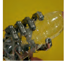
Protezlerin parmak uçlarına yerleştirilen sensörler ile kişiye hissetme duygusu kazandırılarak kavrama eylemi nesnelerin büyüklük ve şekillerine bağlı olarak daha hassas kontrol edilebiliyor.
