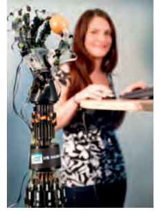
Gelişen malzeme teknolojisi sayesinde yumurta gibi hassas nesneleri zarar vermeden tutabilen yapay tendonlar protezlere entegre ediliyor.
