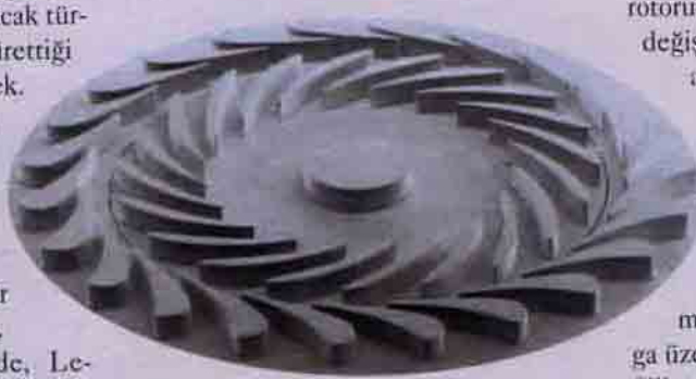
MIT'nin Gaz Türbini Laboratuvarı'nda, geliştirilen 4 mm'lik bir mikrotürbin rotoru.
