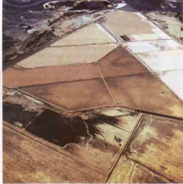
San Francisco Koyu yakınlarındaki bir deniz suyunu buharlaştırıp tuz elde etme sistemi. Havuzlarda üreten halobakteriler kırmızı rengin ortaya çıkmasına neden olur.
