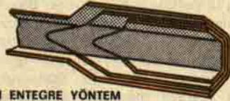
ŞEKİL 3. YARI ENTEGRE YÖNTEM İLE HAZIRLANMIŞ BİR KIRIŞ BAŞLIĞI.
