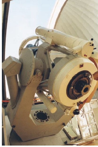
TÜBİTAK Ulusal Gözlemevi’ndeki büyük teleskop. Bu teleskop, 150 cm çaplı aynaya sahip.
