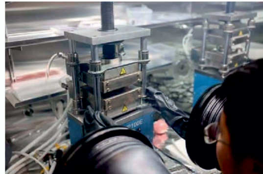
İki boyutlu metal üretmek için kullanılan örs sistemi
