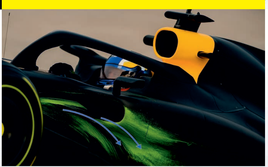
Flo-vis, hava akışının aracı nasıl etkilediğini anlamak için kullanılan bir tür boya. Antrenman turlarında araca sürülür ve sonrasında kızılötesi ışık kullanılarak ayrıntılı şekilde fotoğraflanır.
