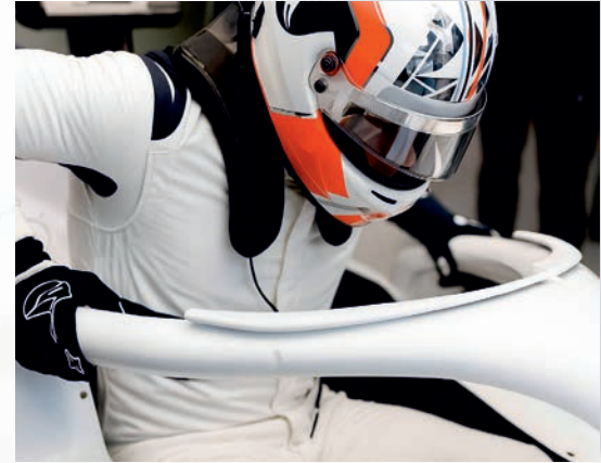
“Halo” kokpit koruması yaklaşık 7 kg’dır ve minimum ağırlık sınırını yükseltmiştir.
