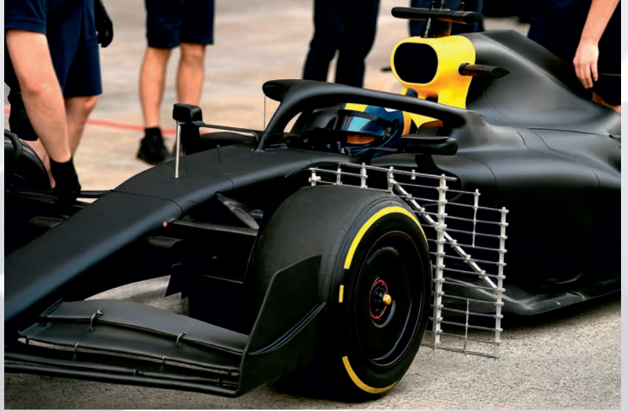
Aerodinamik kafes, metal bir çerçeveye yerleştirilmiş çok sayıda pitot tüpünden (havanın akış hızını ölçmeye yarayan cihaz) oluşur. Takımlar, bu tür cihazları kullanarak pist testlerinde hava akışının ayrıntılı ölçümlerini yapar. Elde edilen veriler, rüzgâr tüneli ve CFD simülasyonlarının sonuçlarıyla karşılaştırılarak simülasyonlarda kullanılan aerodinamik modellerin doğruluğu geliştirilir. Bu sayede yüksek hızda aracın etrafındaki hava akımı optimize edilerek daha fazla yere basma kuvveti elde etmek ve araca etki eden sürüklenme kuvvetini azaltmak mümkün olur.
