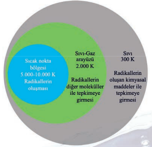
Kavitasyon kabarcıklarının çökmesi sonucu ortaya çıkan kimyasal etkiler
