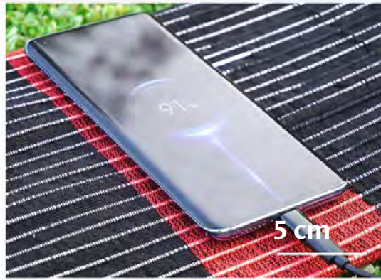
Solda \text{Ca-O}_2 yapılı pil liflerinden yapılan enerji depolayıcı kumaş, sağda bir cep telefonunu şarj etmekte olan bir kumaş pil
