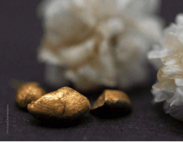
Peynir altı suyundan elde edilen küçük protein lifleri yardımıyla elektronik atıklardan elde edilen altın granülleri
