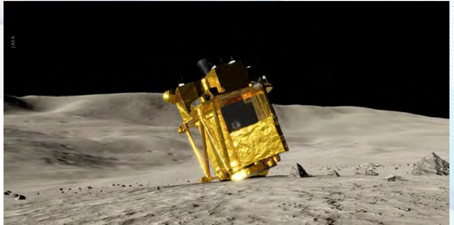
JAXA tarafından hazırlanmış, SLIM'in güneş panellerinin Güneş'ten uzağa yönlenmesine sebep olan hatalı iniş pozisyonunu gösteren temsili bir görsel
