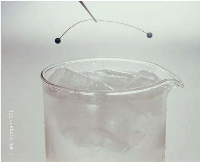
Nitinol telin farklı sıcaklıklarda şekil değiştirmesi
