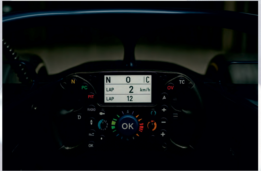
Bir Formula 1 aracının direksiyonunda sürücünün aracın dinamiklerini değiştirmesini sağlayan birçok ayar düğmesi bulunur
