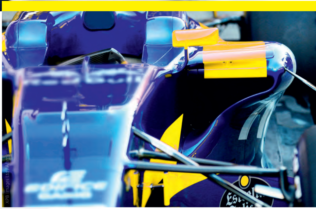
Sidepod, Formula 1 araçlarının yan tarafında bulunan, motorun soğutulmasının yanı sıra araca etki eden yere basma kuvvetini artıran bölümlerdir.
