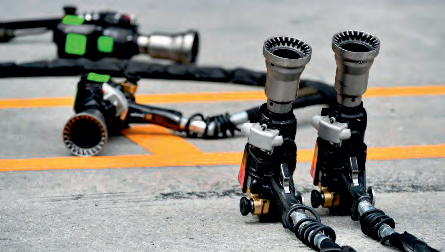
Modern Formula 1 bijon tabancaları, üzerlerindeki sensörler ve elektronik kontrol üniteleri sayesinde, her pit stopta milisaniye ölçeğinde zaman kazandırarak pitstop sürelerinin kısaltılmasına katkıda bulunuyor.
