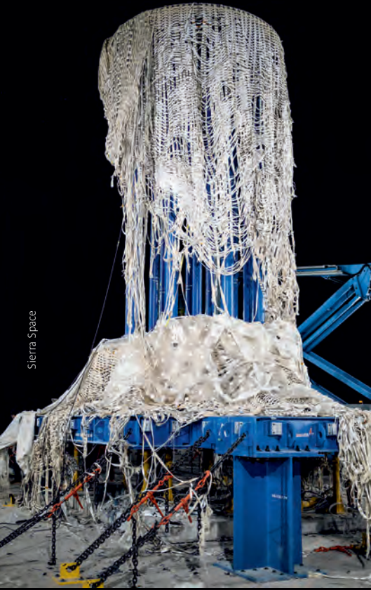
LIFE modülün tam ölçekli modelinin UBP testinden sonraki görüntüsü
