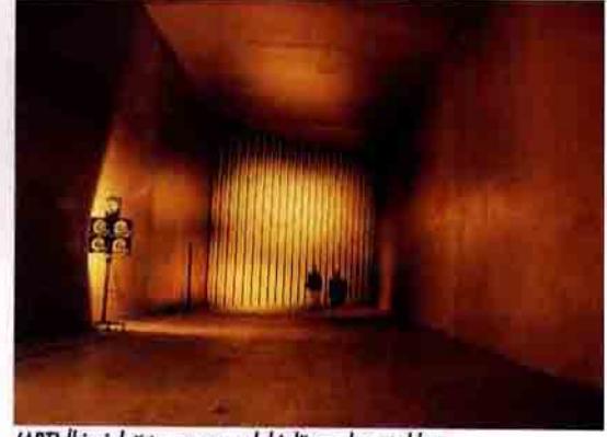
(ART) İkinci dağıtıcı ve sonundaki dönme kanatçıkları
