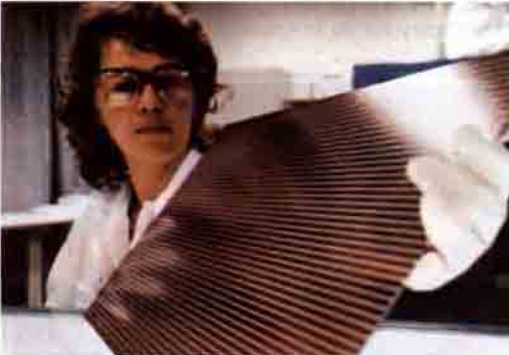
Bu pencere camı, küçük bir santraldir. Cama binde bir milimetre kalınlığındaki bir silisyum tabakası yapıştırılmıştır. Bu kristal olmayan ince tabaka teknolojinin verim oranı % 8'dir. Bununla birlikte, ileride %20 ye kadar yükseltilmesi planlanmaktadır.
