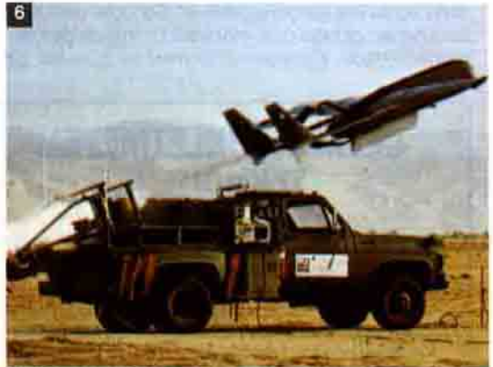
6 Pacific Aero System firmasının geliştirdiği bu RPV, gözetleyici olarak görev yapabilmektedir.
