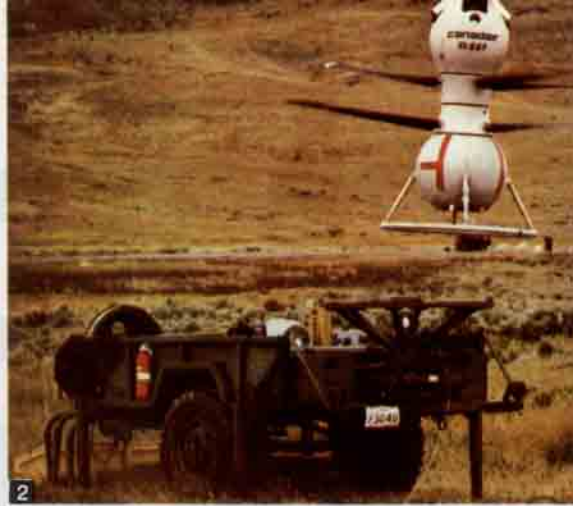
Canadair firması tarafından geliştirilen başka bir RPV. Eksenî etrafında dönen pervaneleri yardımı ile istenilen yere inebilir.
