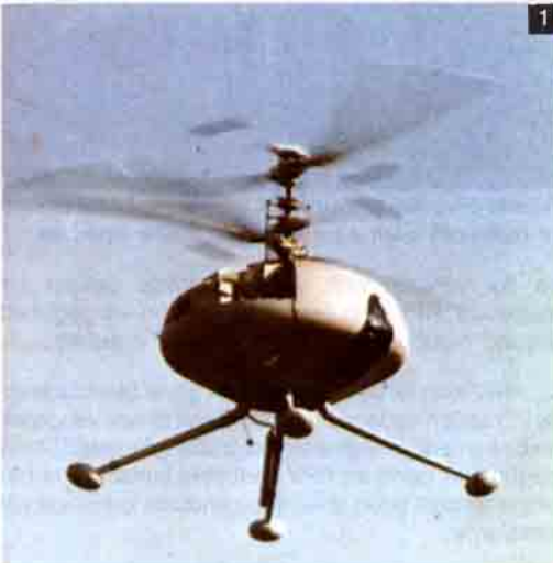
Otomatik olarak kontrol edilen pilotsuz bir heli- kopter.
