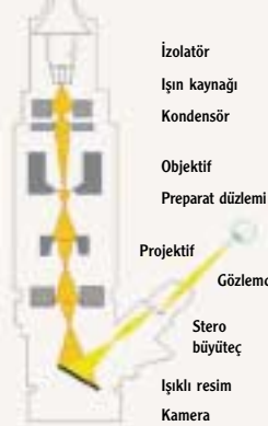
Bir elektron mikroskopunun yapısı
